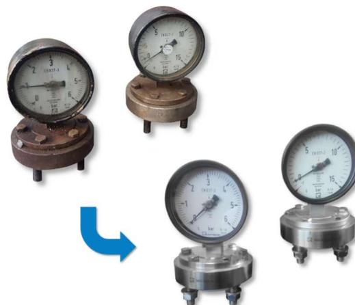
Plattenfedermanometer – Zuvor stark abgenutzt, nun wieder vollständig erneuert und einsatzbereit
