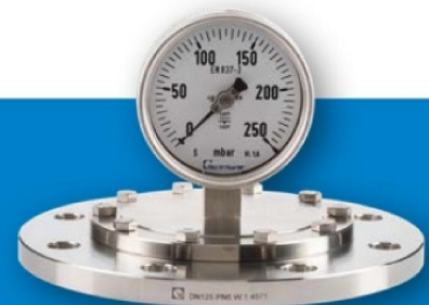
Bild: PGU 100 Plattenfeder- manometer mit V 151 An- schlussflansch DN125 PN6
