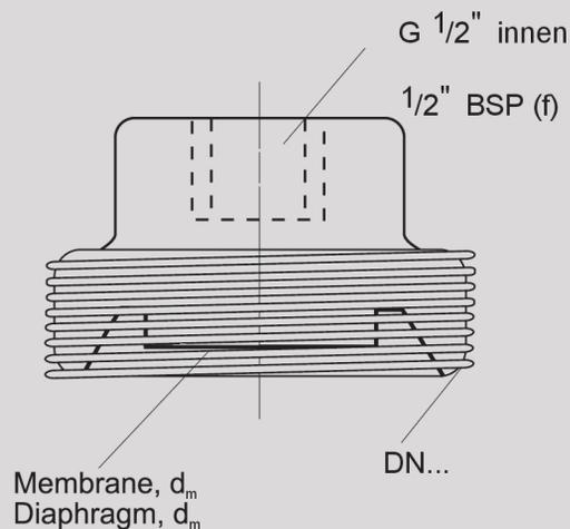
**Druckmittler DIN 11851 / Seals DIN 11851**
